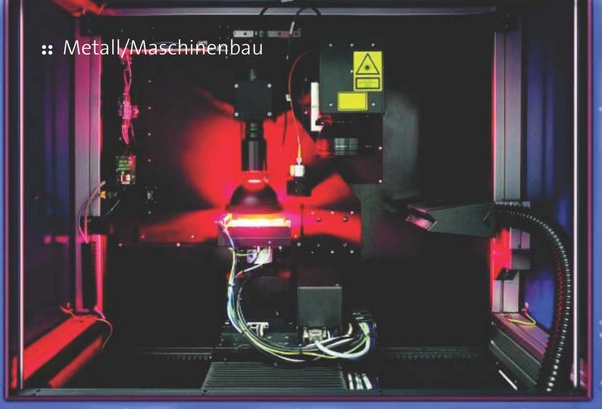
Laserschneidanlage für Leiterplatten mit Inline-Messtechnik: In der Mitte befindet sich das Transportsystem mit Magnetmaske zur Klemmung der Bauteile, darüber das Vision-System mit dem über Lichtleiter angeschlossenen konfokalen Sensor, rechts darüber der Scannerspiegel des Ultrakurzpulslasersystems mit der telezentrischen Optik
