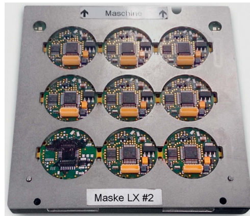
Neunfachnutzen: Die Bauteile müssen kreisrund ausgeschnitten werden. Hier kommt erstmalig ein UKP-Laser zum Einsatz. Foto: © iC Haus
