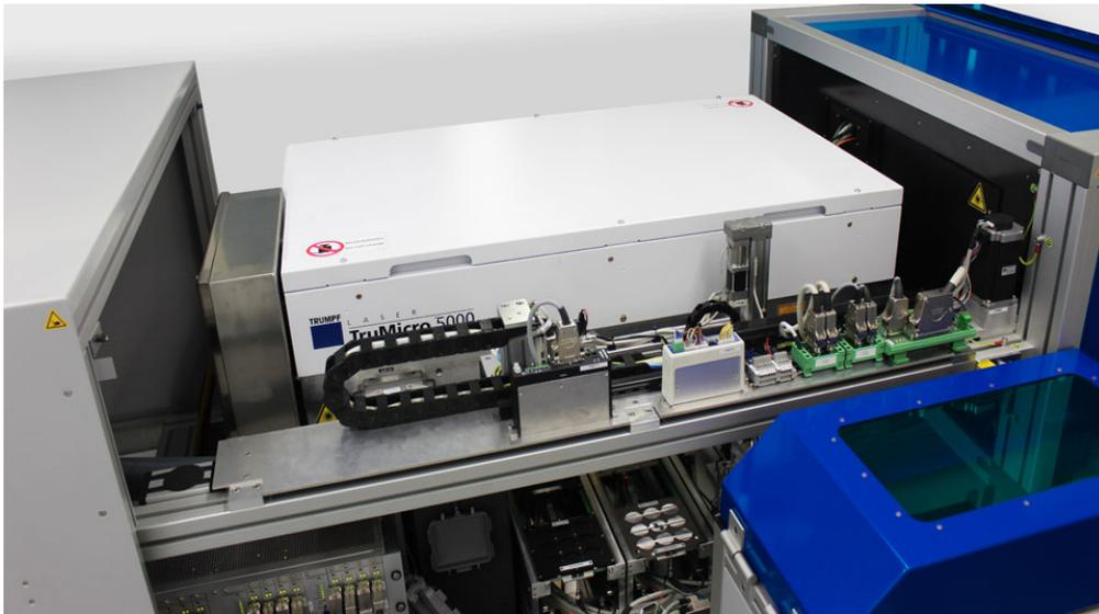
Das Triebwerk im Lasertrenner: Ultrakurzpuls-Laser von Trumpf mit 30 W und 150 µJ Pulsleistung. Foto |ic-automation
