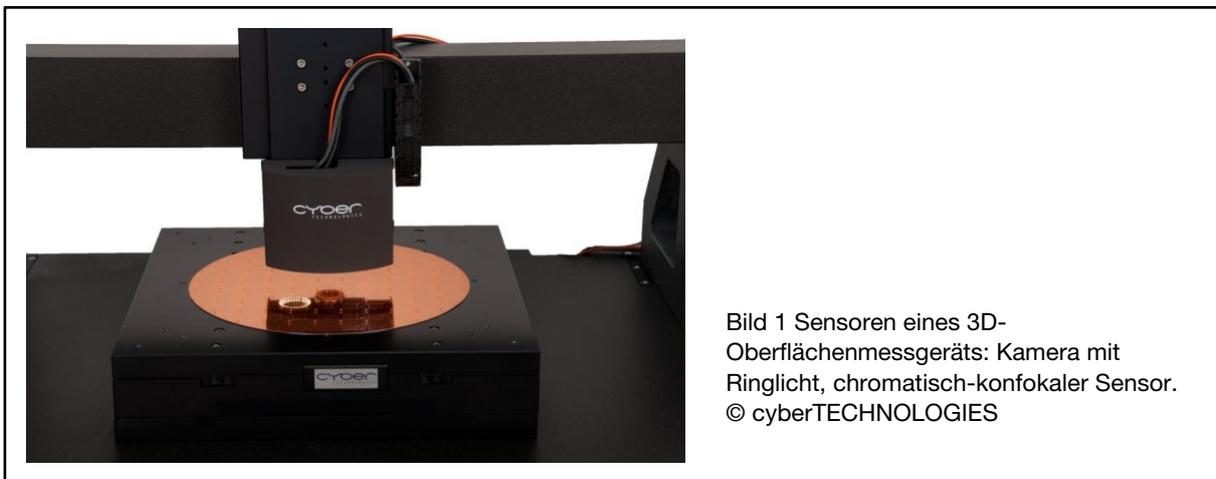
Bild 1 Sensoren eines 3D-Oberflächenmessgeräts: Kamera mit Ringlicht, chromatisch-konfokaler Sensor.
