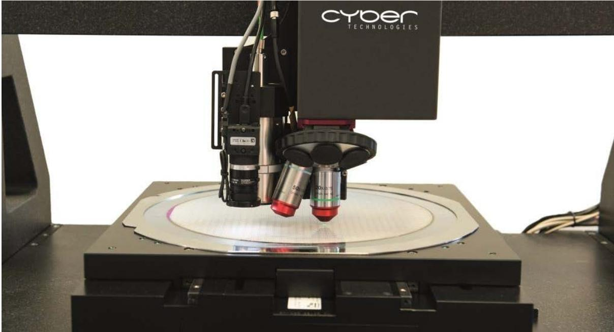
3D-Messtechnik für elektronische Bauteile: Kameras, optische Sensoren, Konfokalmikroskope. © cyberTECHNOLOGIES
