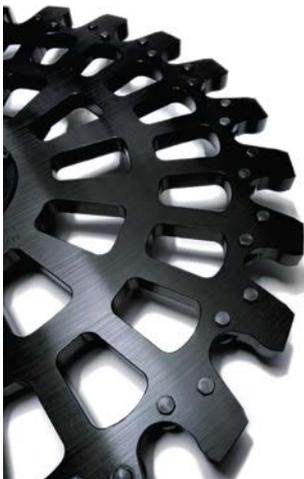
**Bild 1.** Schrittgeschaltetes Sternrad einer Inspektionsmaschine. Es folgt einem Schrittschalt- und Ruhezyklus und übernimmt Artikel von einem Förderband. In jeder Ruhestellung erfolgen durch festeingebaute Messköpfe Prüfungen wie beispielsweise Wandstärkemessungen. © Heye International
